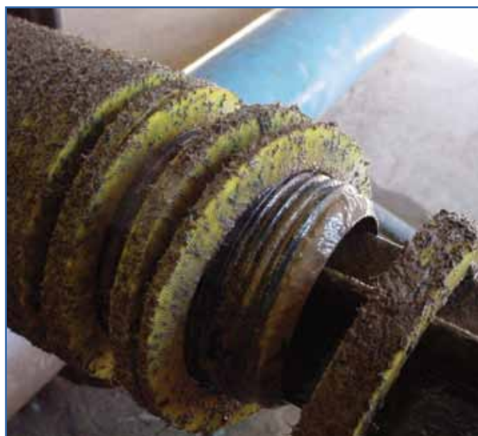
Figuur 4: Indien die kapasiteit van die filter nie geskik is vir die vloeitempo of vuilheid van die water wat gefiltreer moet word nie, sal filtrering ondoeltreffend en drukverlies onnodig hoog wees.
